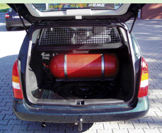
Nachteil der CNG-Ausrüstung ist der Platzbedarf für die Druckgasbehälter
